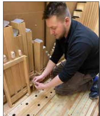
Orgelbauer Alexander Ortman beim Intonieren der Pfeifen des Registers Philomena 8'
